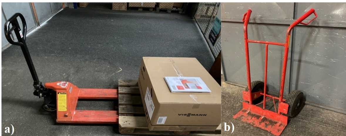
Obrázek 17 Manipulační prostředky: a) nízkozdvižný paletovací vozík; b) rudly
