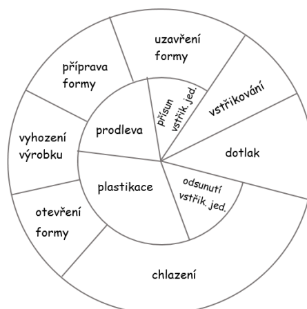
Obrázek 5 Vstřikovací cyklus, vnější část – vstřikovací forma, vnitřní část – vstřikovací jednotka
