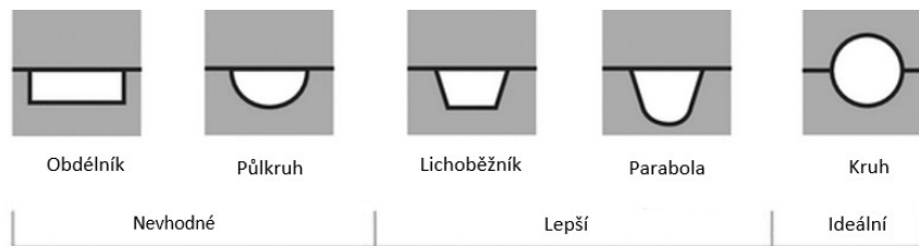
Obrázek 24 Průřezy rozvodných vtokových kanálů [28]
