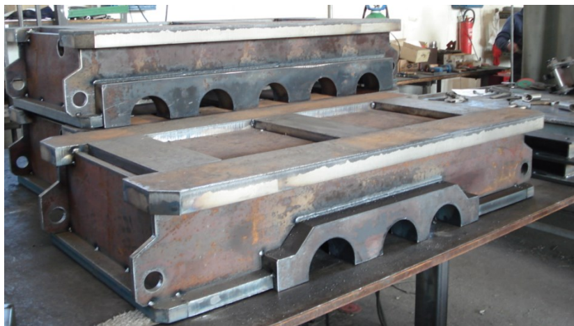
Obr. 16.: Svařenec části rámu stroje. [23]
