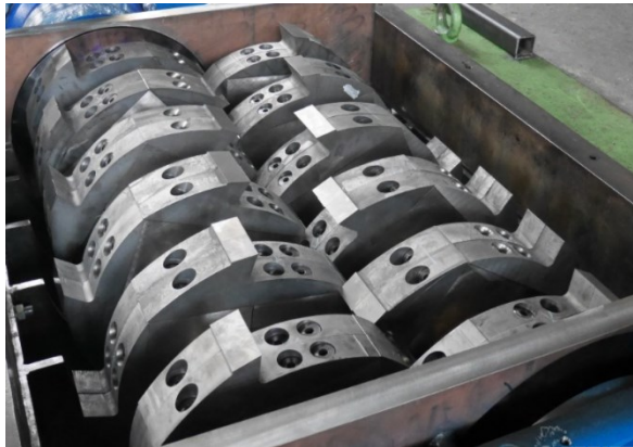
Obr. 14.: Pohled na pracovní část Dvouhřídelového drtiče. [16]
