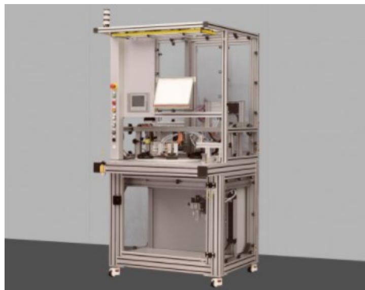
Obr. 18.: Jednoúčelový stroj z hliníkových profilů. [27]
