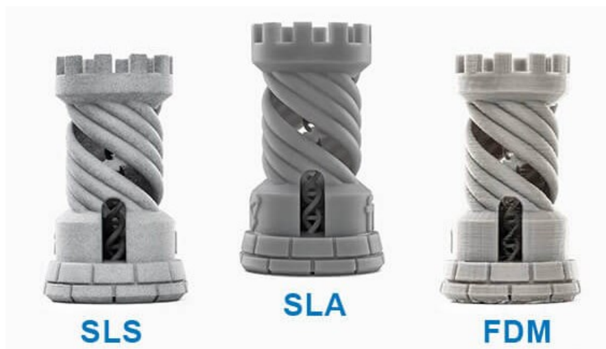
Obr. 5.: Porovnání výtisků technologií 3D tisku SLS, SLA a FDM [9]
