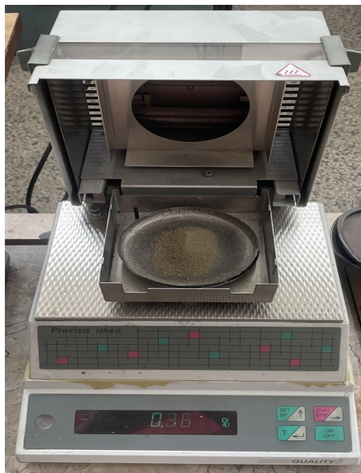
Obrázek 36 Měření podílu vlhkosti na váze Precisa HA60
