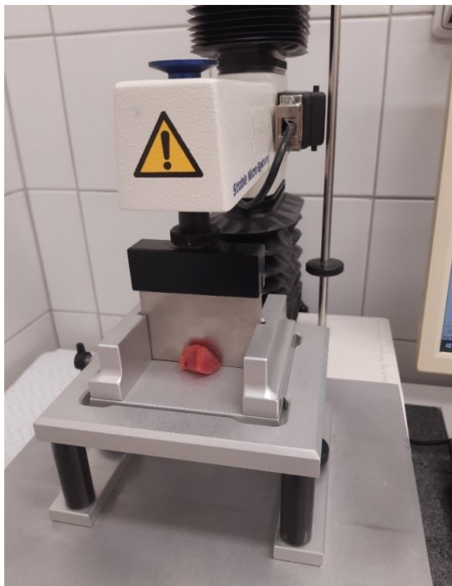
Obrázek č. 21 – Měření texturních vlastností u hovězího masa
