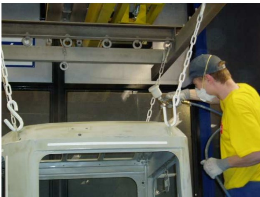
Obrázek 3 - Nanesení základního laku pracovníkem lakovny
