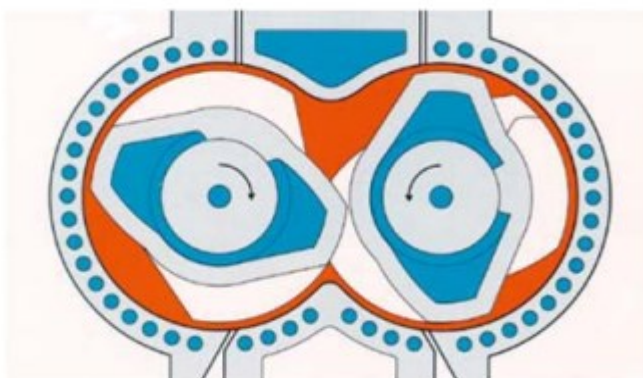
Obrázek 7: Vysokotlaké hnětiče s do sebe zapadajícími hněťadly [16]
