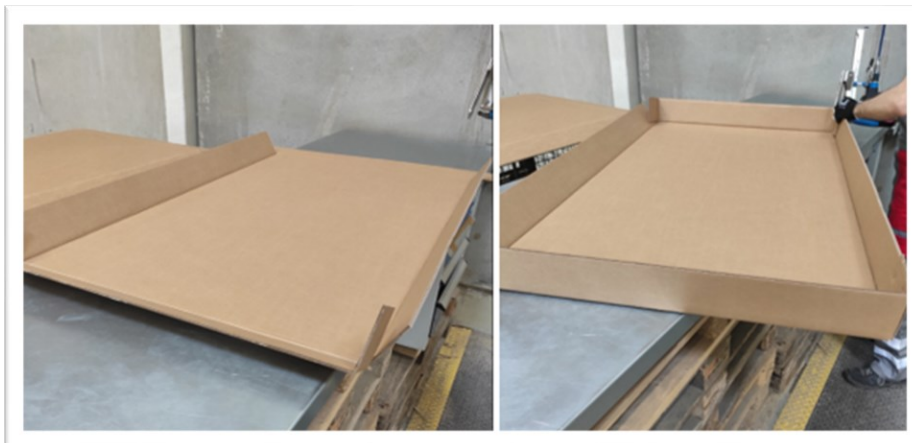
Obrázek 14 Průběh činnosti při kompletaci vík (zdroj: vlastní)
