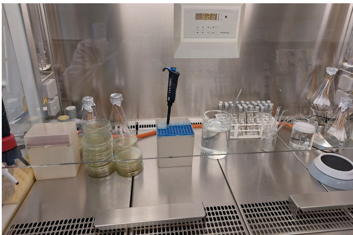
Obrázek 32 Laminární box připravený k pipetování a roztěru roztoku konzervantu a bakteriální suspenze
