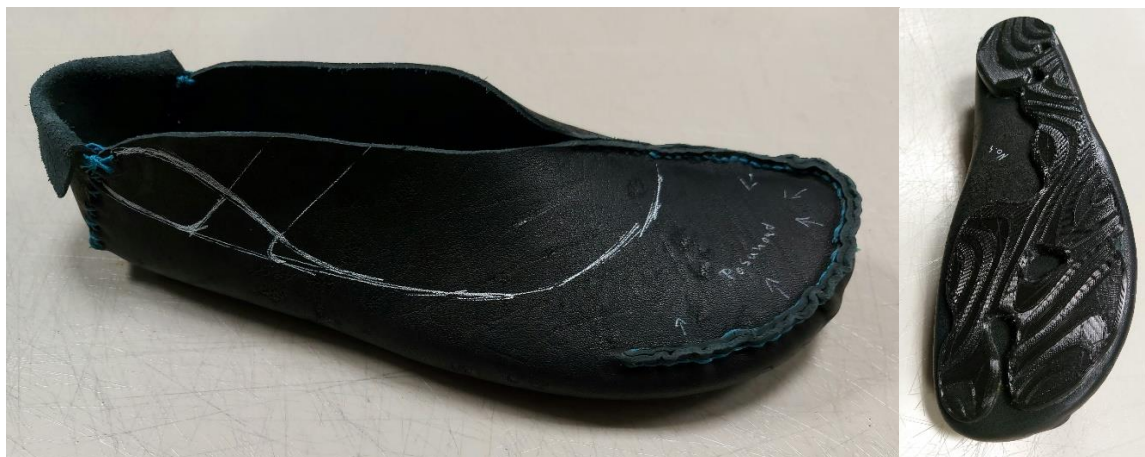
24 Jeden ze zkouškových modelů obuvi BI-PO a první zkouška lepení podešve
