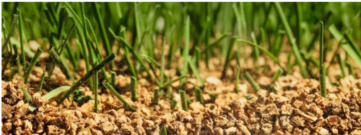
Obr. 20 Posyp drceného korku na fotbalovém hřišti
