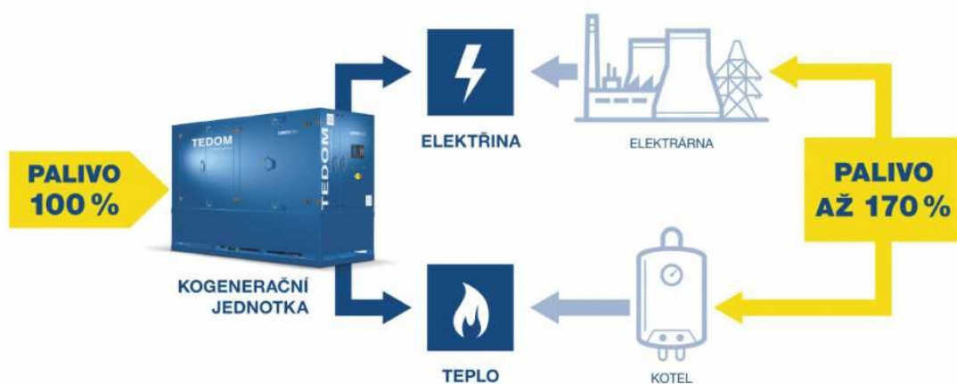
Obrázek 1 Princip kogenerace (TEDOM a.s., b.r.)
