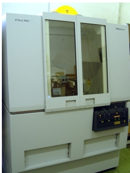
Obrázek 20: RTG difraktometr Panalytical X'Pert PRO [39]
