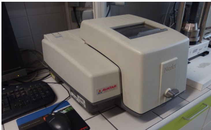
Obrázek 18: Spektrofotometr FT-IR ATR Nicolet [39]
