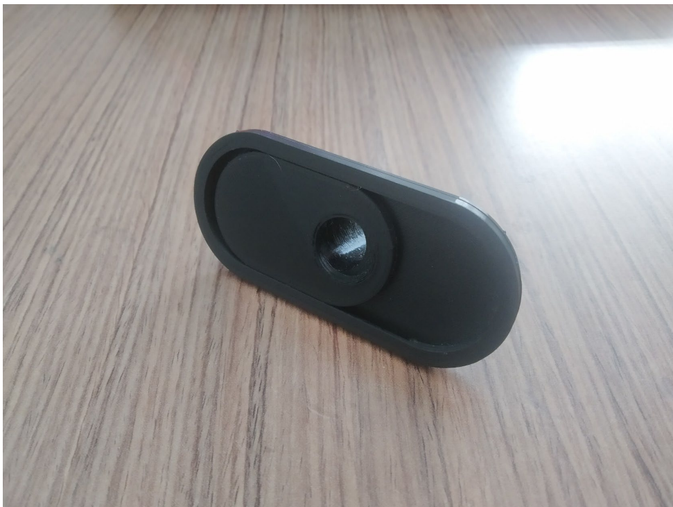
Obrázek 35 – Prototyp česnového uzávěru
