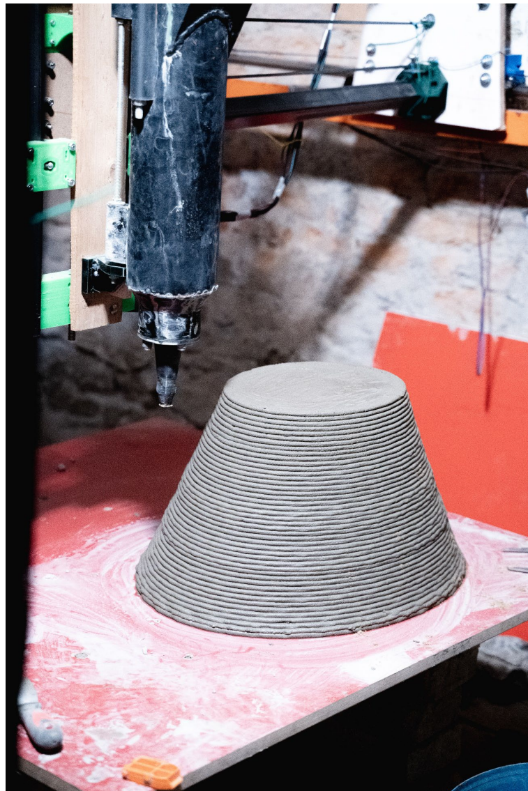
Obrázek 37 – Prototyp tištěného podstavce
