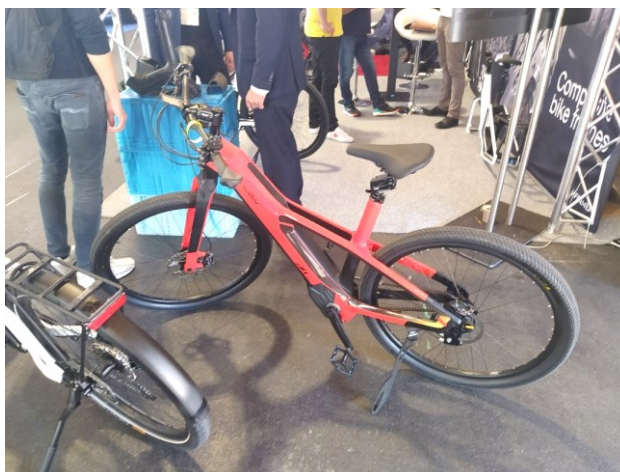
Obrázek 34 Kolo Buddy SX1 ze vstříkovaného plastu
