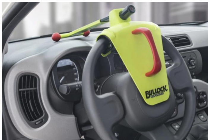
Obrázek 2 Pákový zámek volantu s blokáci airbagu [32]
