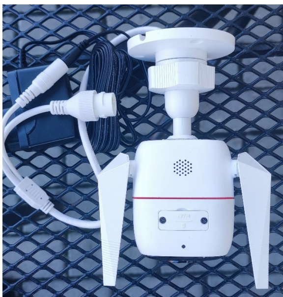
Obrázek 47 Tapo C310 a prostor pro umístění paměťové karty
