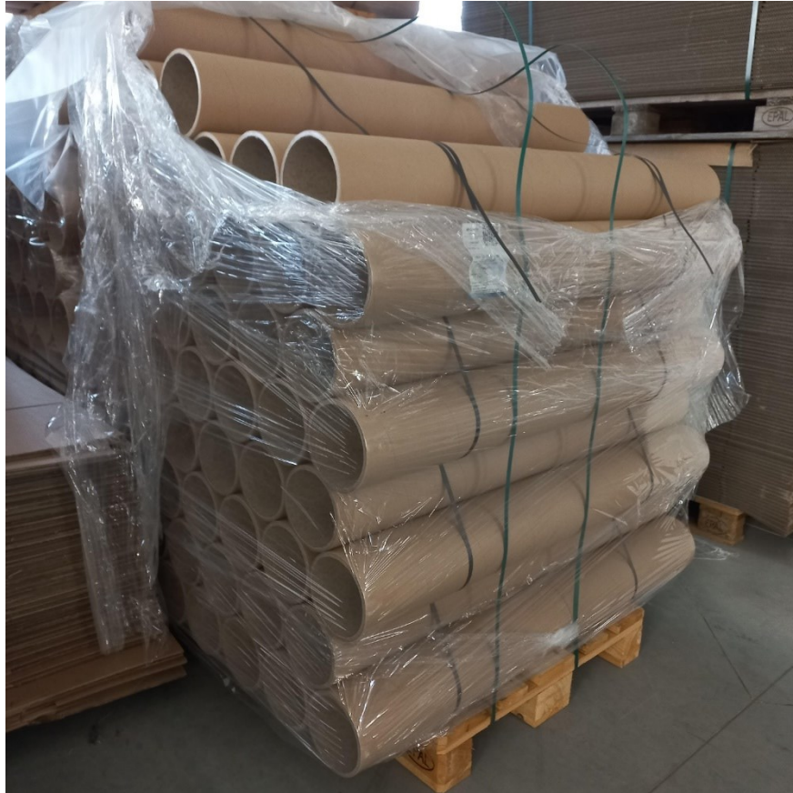
Obrázek 10 Paleta s dutinkami zajištěná proti sesuvu materiálu (vlastní zpracování)
