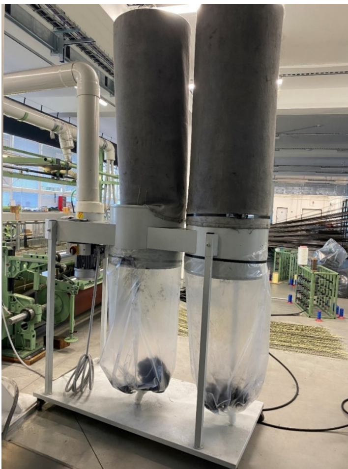
Obrázek 8 Odsávání prachu a nečistot (vlastní zpracování)
