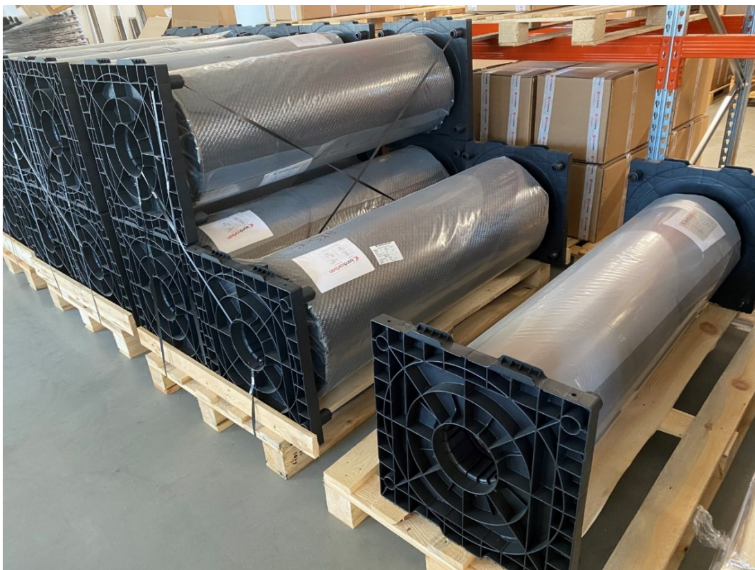
Obrázek 9 Ukotvení výrobků na paletě (vlastní zpracování)
