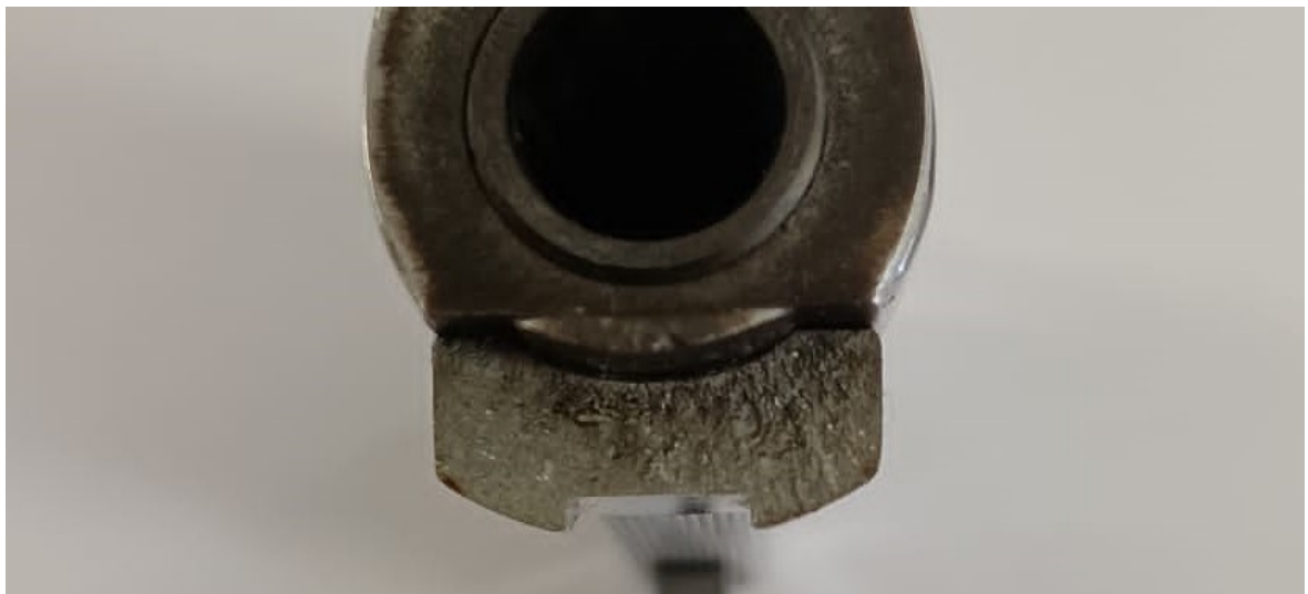
Obrázek 26 Detailní pohled na vrchní odlomenou část [vlastní zdroj]
