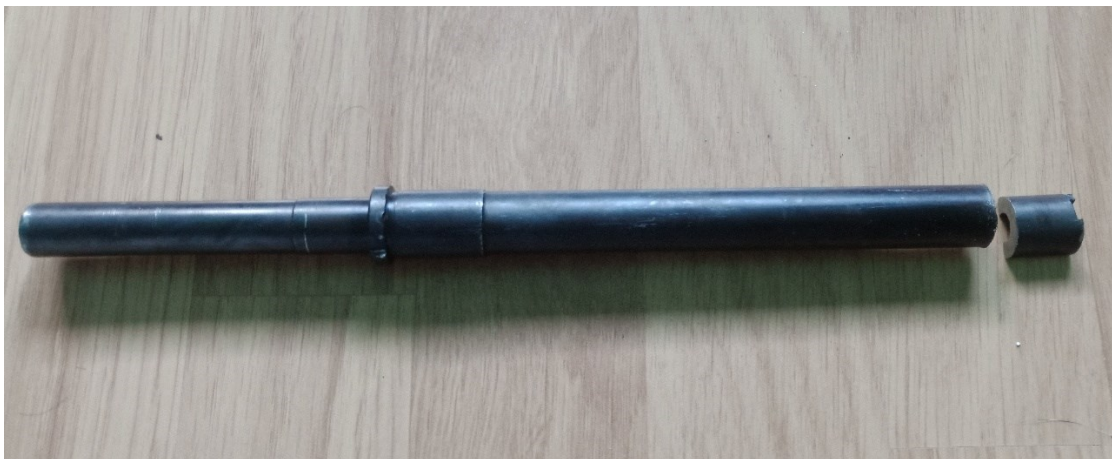
Obrázek 21 Místo odběru vzorku z hlavně samopalu 26 [vlastní zdroj]
