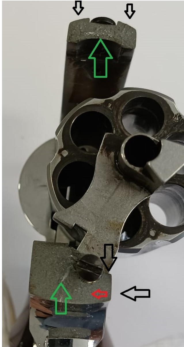
Obrázek 27 Detailní pohled na místa lomů rámu revolveru [vlastní zdroj]
