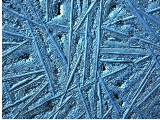
Obrázek 14 Mikrostruktura ledeburit a primární cementit [13]
