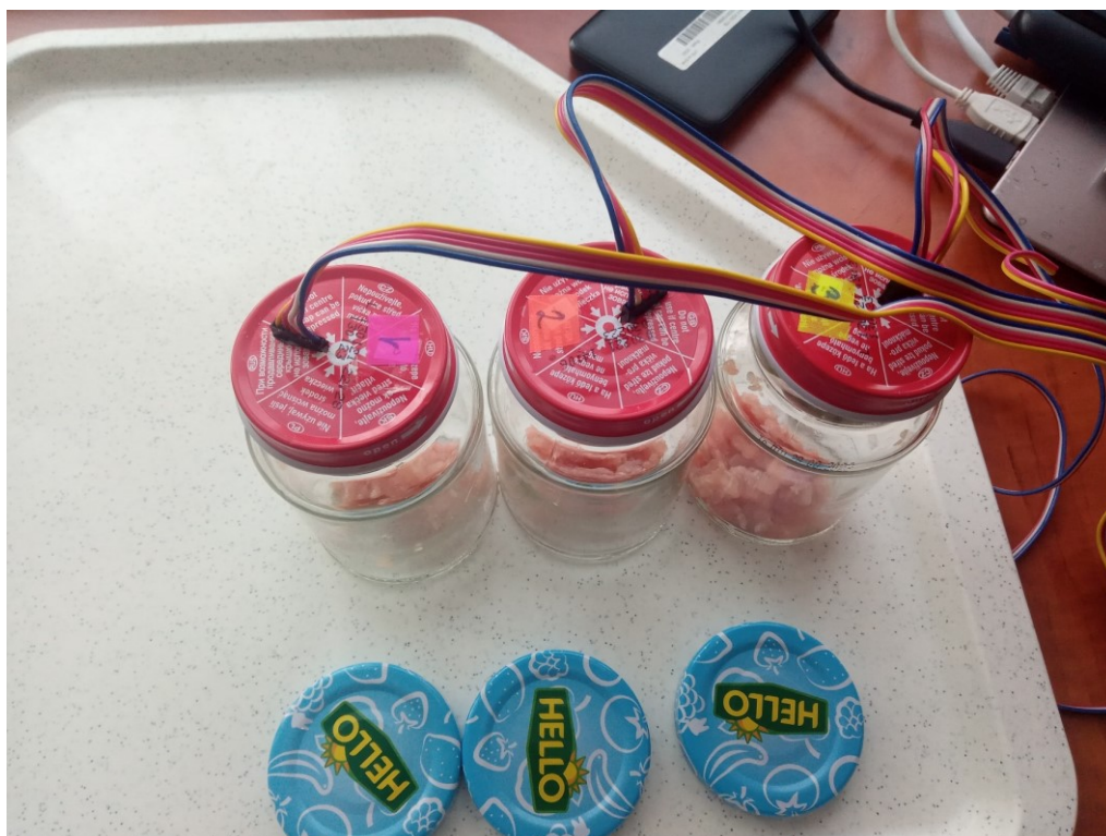
Obrázek 14: Vzorky drůbežního masa o hmotnosti 15 g opatřené senzory, mikrokontrolér Měření probíhalo každý den ráno (označeno jako R) a večer (označeno jako V) ode dne započnutí experimentu (Den 0 – 1 den až po zkažení) do dne, kdy se vzorek projevoval silným zápachem. Výjimkou byl Den 3 R, kdy měření nebylo provedeno.
