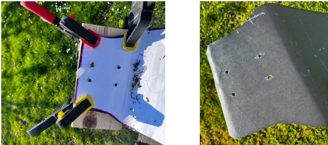
Obr. 83.: Vrtání děr do kompozitní desky
