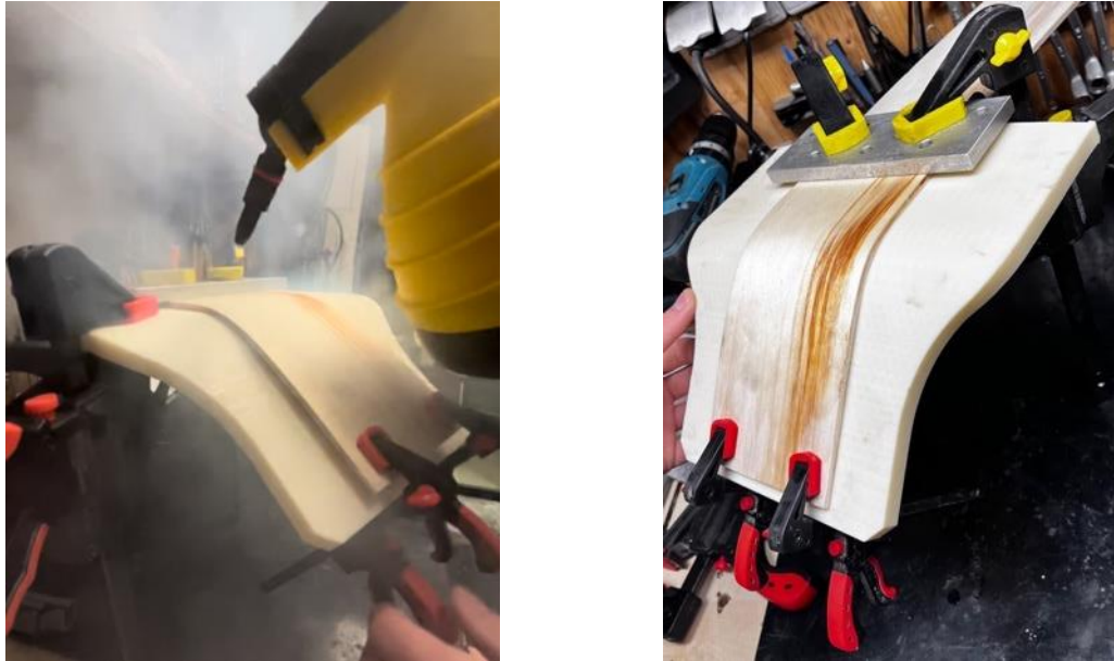
Obr. 63.: Test ohybu topolové překližky
