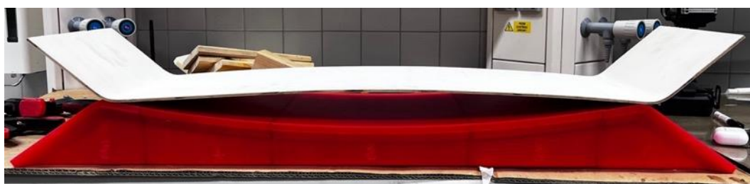
Obr. 71.: Tvarované jádro, po sundání z formy
