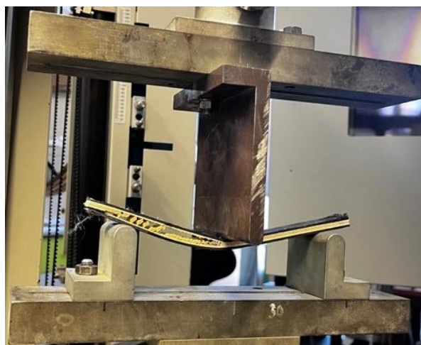
Obr. 68.: Ohybová zkouška – jádro topolová překližka
