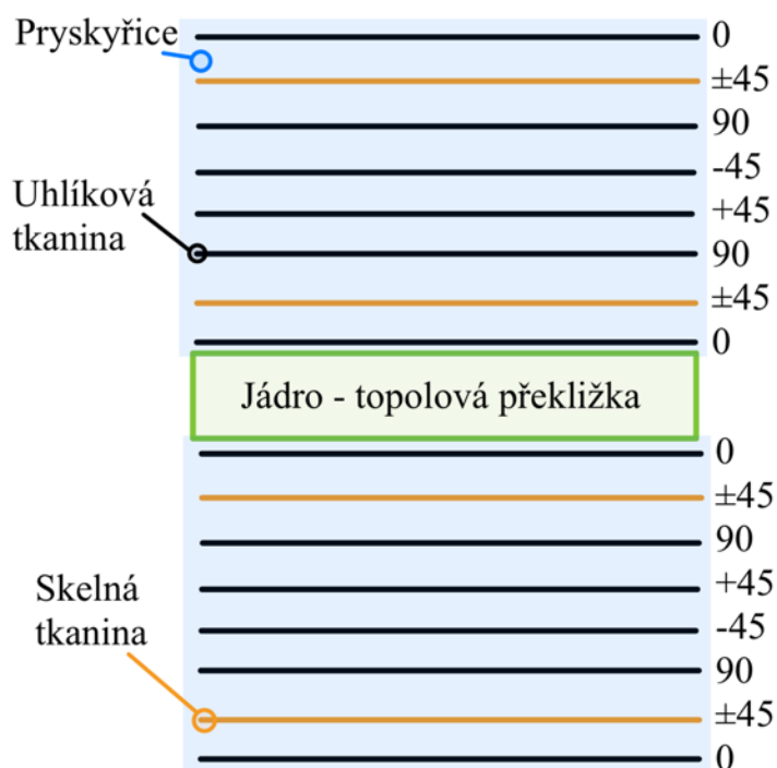
Obr. 72. Skladba potahu pro mountainboardovou desku
