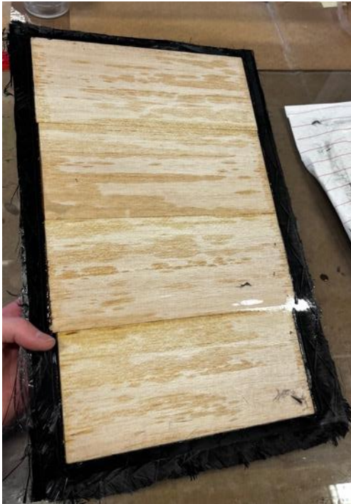
Obr. 50.: Sendvičová deska – pohled ze strany následného nanášení uhlíkové tkaniny
