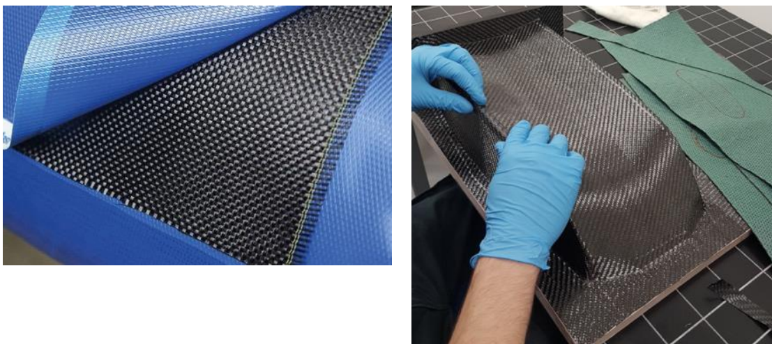
Obr. 19. Prepreg, výroba dílu z prepregu [2,17]
