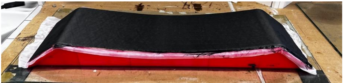
Obr. 76.: Fotografie výrobku s formou po odstranění technologických materiálů
