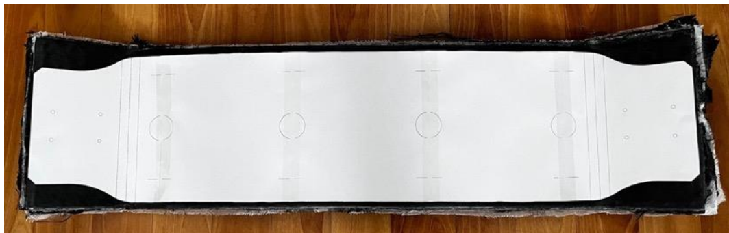
Obr. 81.: Vyznačení tvaru mountainboardové desky na vyrobenou desku
