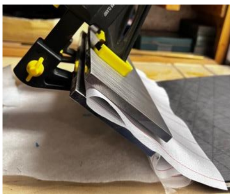
Obr. 84.: Oprava delaminované tkaniny
