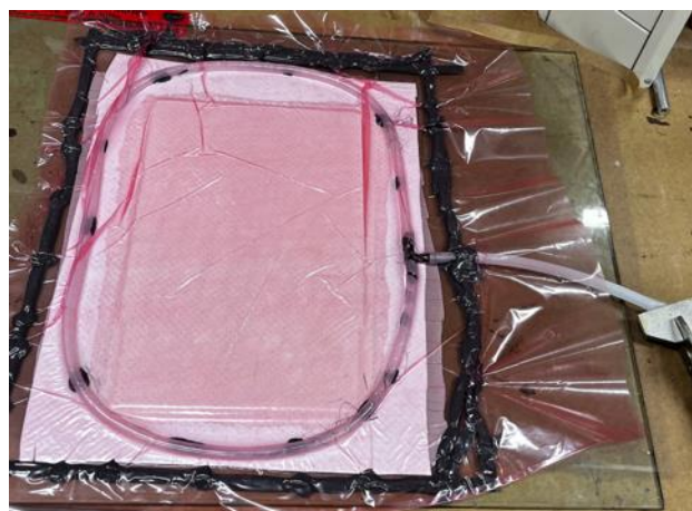
Obr. 49.: Odsátí přebytečné pryskyřice
