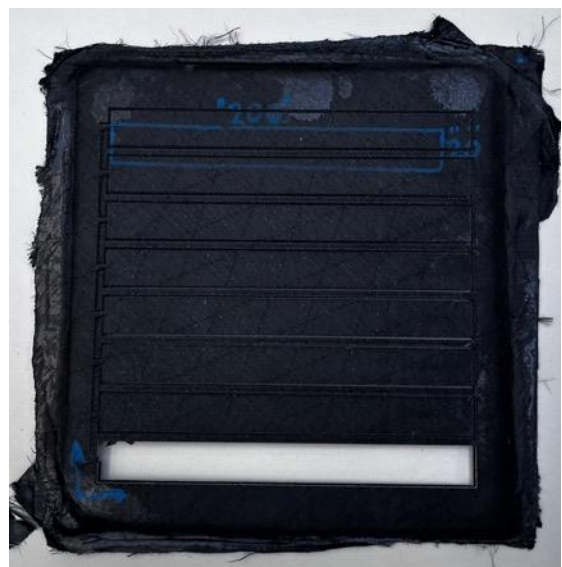
Obr. 55.: Tělíska nařezána pomocí vodního paprsku
