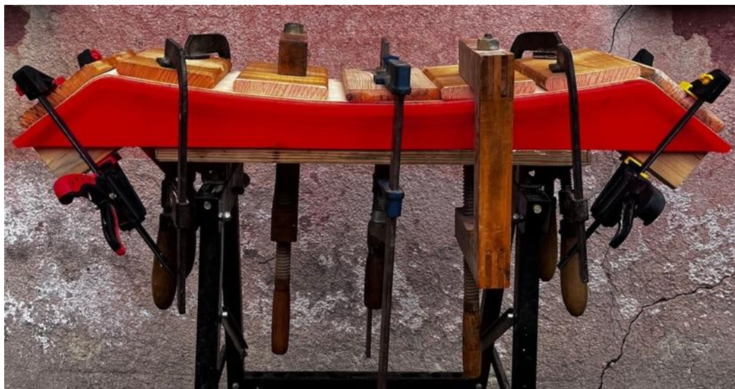
Obr. 70.: Tvarování topolového jádra k tělu formy
