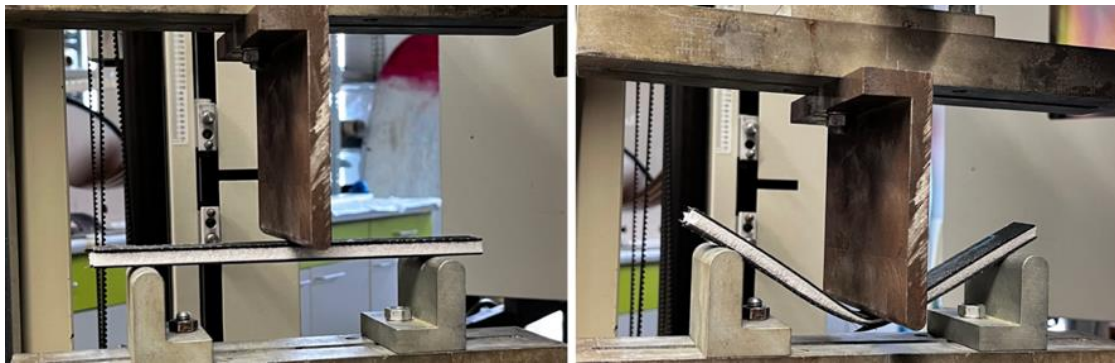
Obr. 61.: Ohybová zkouška – jádro pěna
