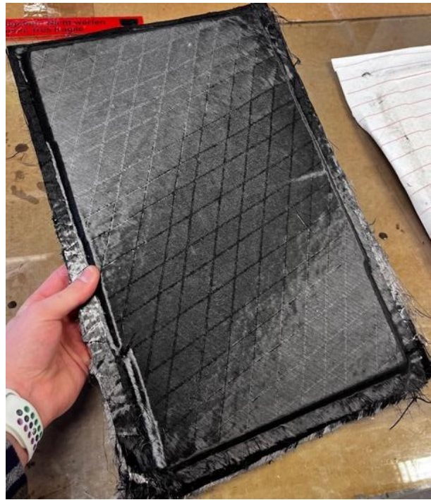
Obr. 51.: Kompozitní deska – pohled na vytvrzenou uhlíkovou tkaninu
