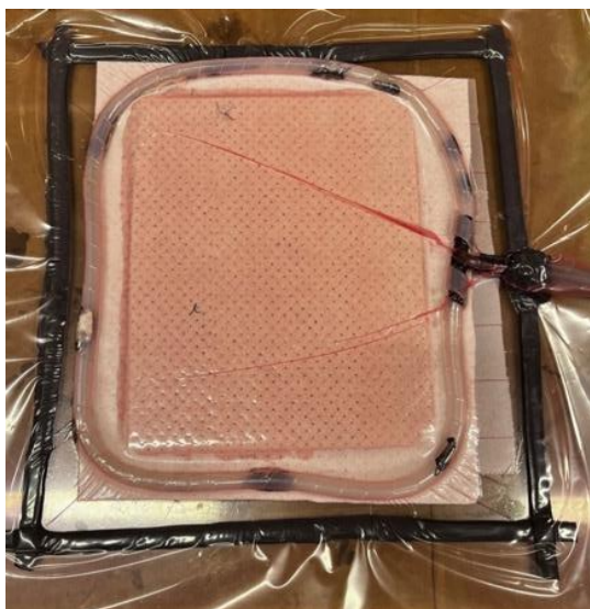
Obr. 64.: Výroba modifikovaných těles
