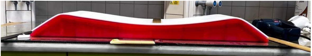
Obr. 58.: Formování polystyrénové pěny
