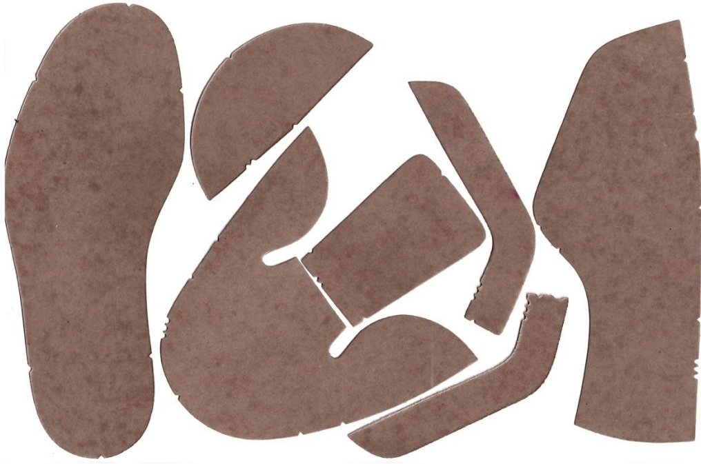
Obrázek 41: tvary použitých vysekávacích nožů (zdroj: vlastní archiv, 2023)
