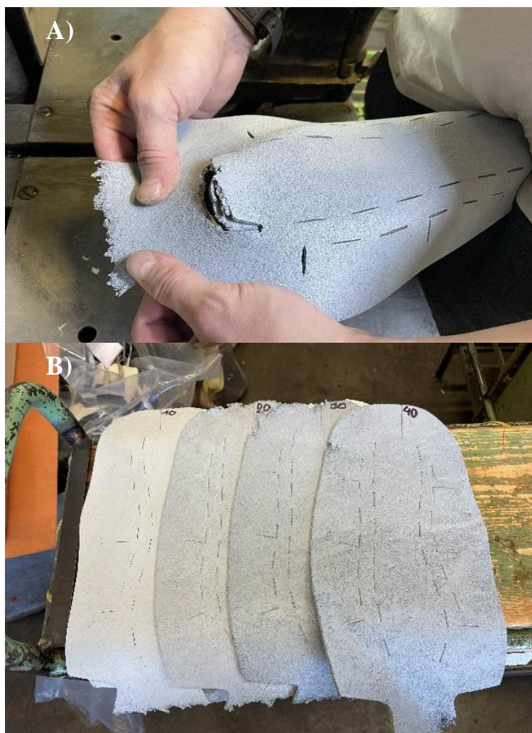
obrázek 25: hotové vzorky směsi pro výrobu podešví:
