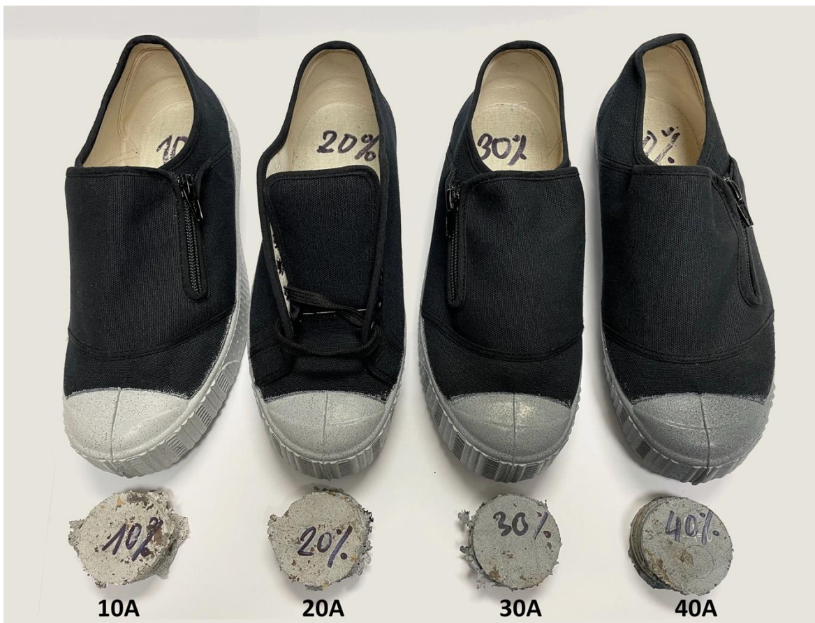
Obrázek 32: čtyři modely obuvi s podešví s příměsí pneumatikové drtě (zdroj: vlastní archiv, 2023)
