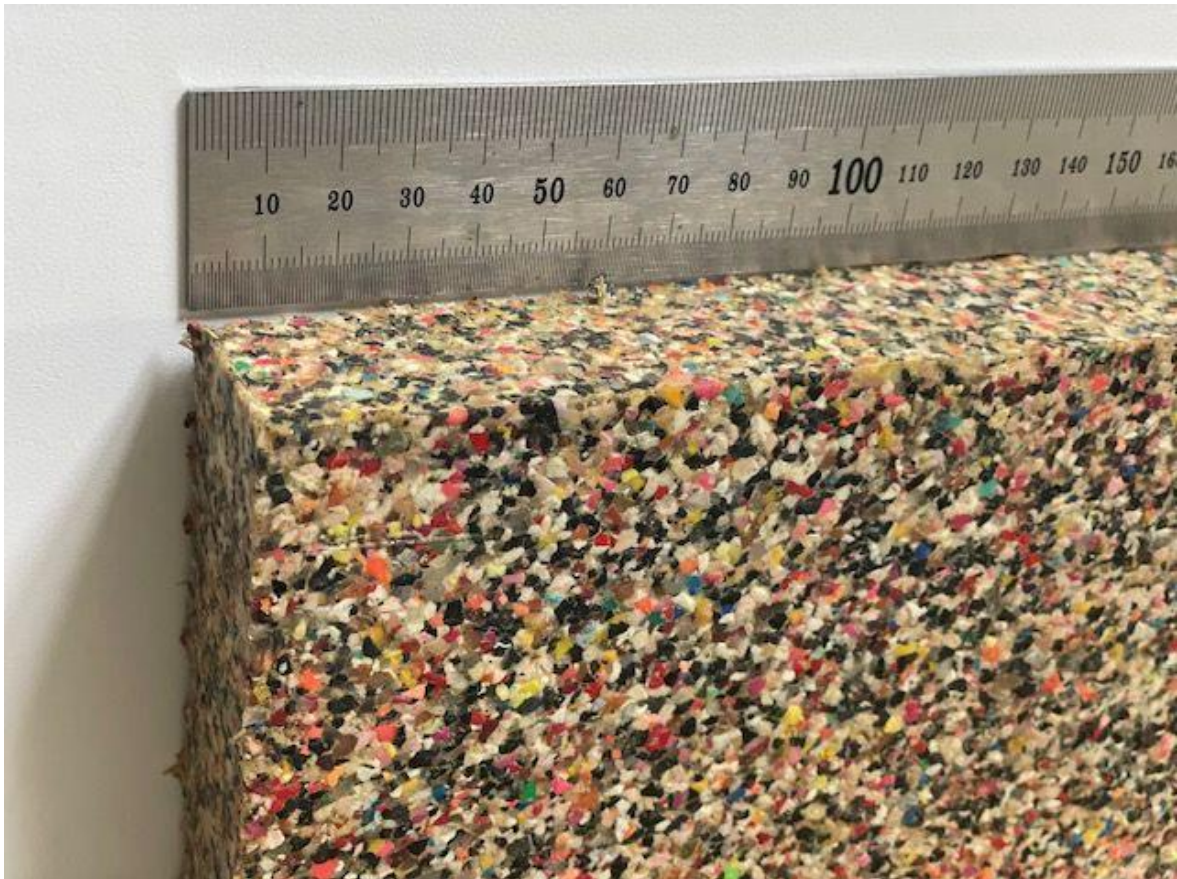
Obrázek 27: vzorek lisovaného bloku pro protihlukovou stěnu z recyklovaných tenisek (zdroj: vlastní archiv, 2023)
