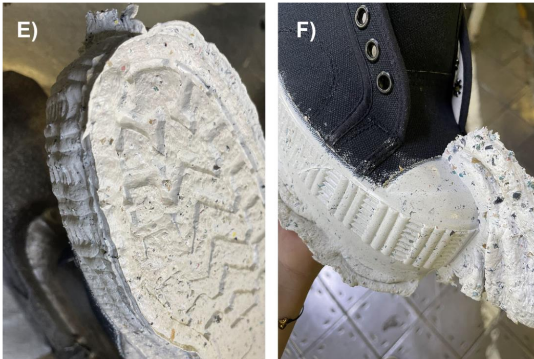
Obrázek 22: výroba materiálu pro podešve obuvi: A) míchání materiálu B) tažení materiálu C) surový materiál v řezu D) lisování materiálu E) vylisovaný prototyp obuvi, 20% podíl recyklátu F) detail vylisované špičky obuvi
