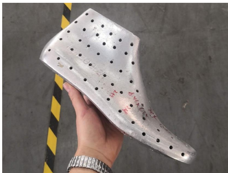
Obrázek 28: hliníkové kopyto pro varování svršků horkou párou. (zdroj: vlastní archiv)
