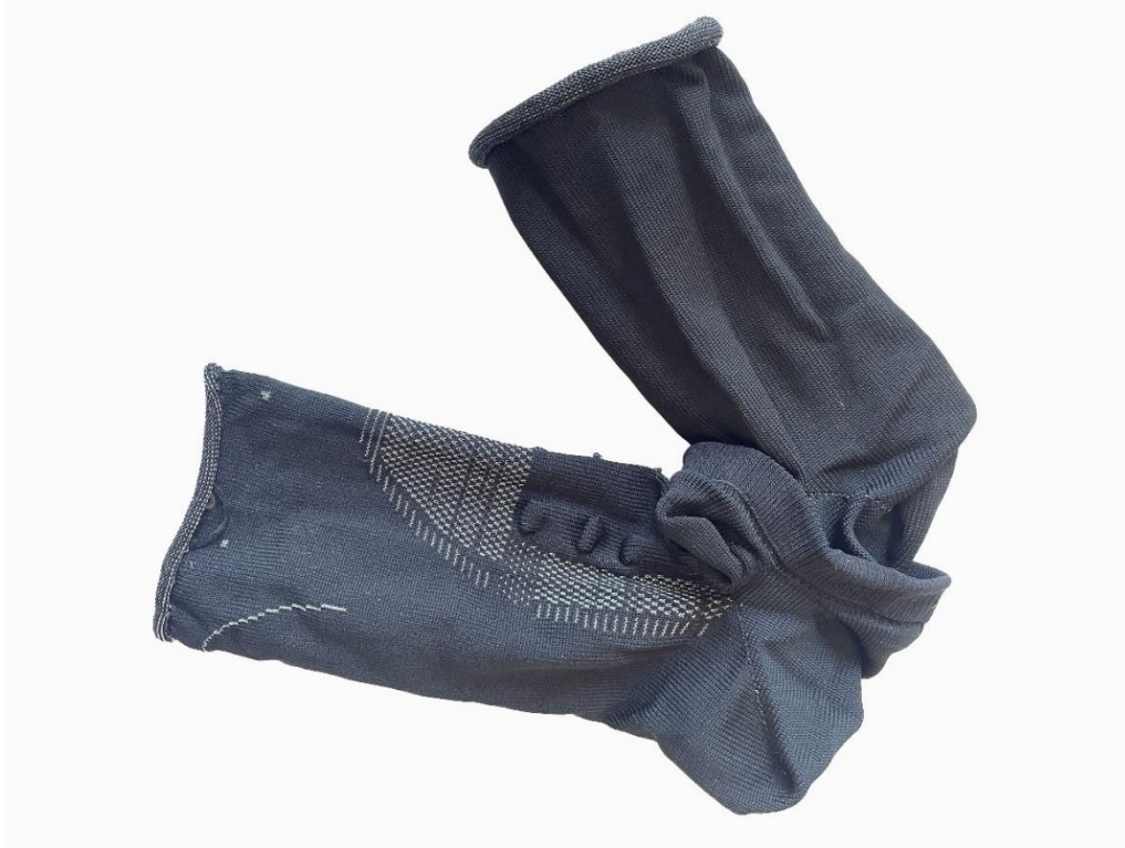
Obrázek 29: Svršek upletený na kruhovém pletacím stroji před tvarováním (zdroj: vlastní archiv)
