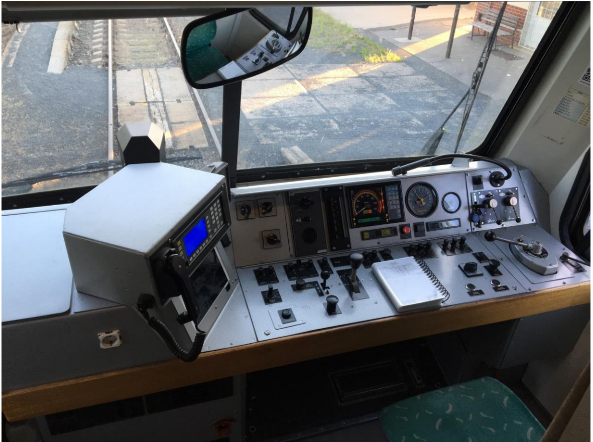
Obrázek 9 Stanoviště strojvedoucího staršího vozidla „klasické“ koncepce
