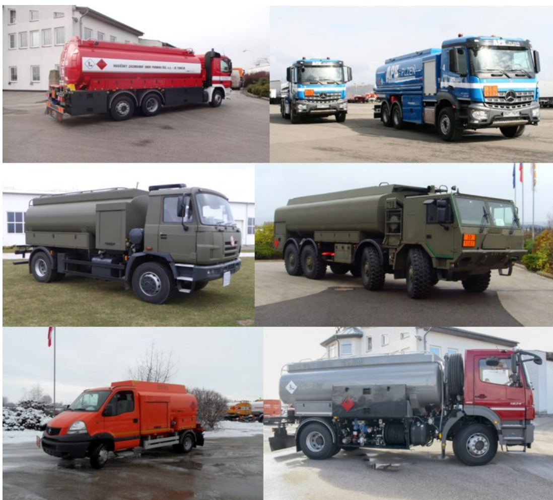
Obrázek 25 Cisterny ADR s možností terénního výdeje (Kobit 2023b)
