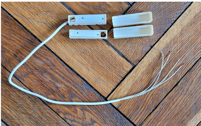
Obrázek 10: Magnetický kontakt MAS 203 (vlastní, 2023)
