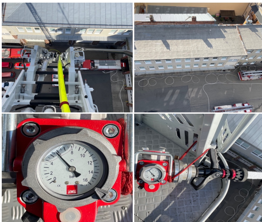
Obrázek 11 Simulace tlakových ztrát na dopravním vedení (Autor, 2023)
