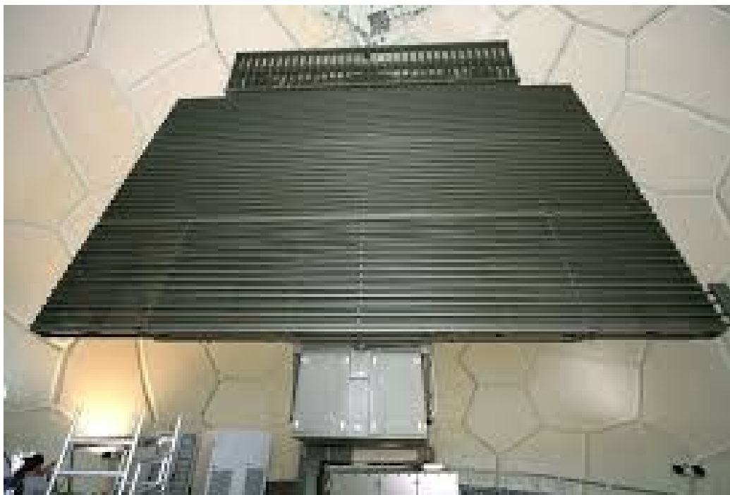
Obrázek 8 – RAT-31DL anténa uvnitř ochranné kopule (Ministerstvo obrany, ©2014)
