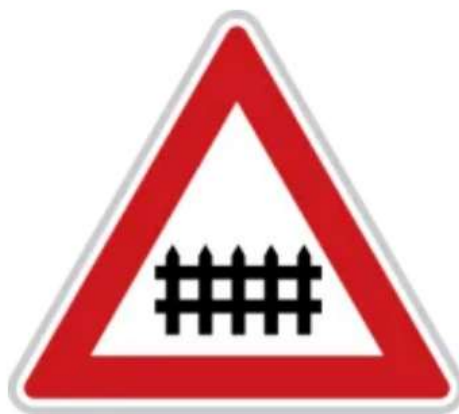
Obrázek 3 Železniční přejezd se závorami
