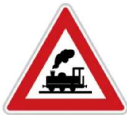
Obrázek 4 Železniční přejezd bez závor
