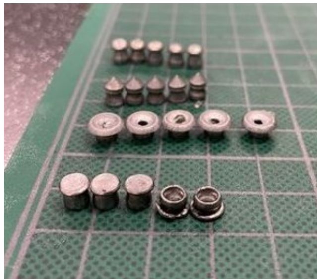
Obrázek 19. Diabolky po experimentu (Vlastní)
