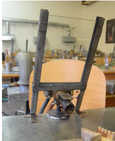
Obrázek 2 – Figurkářský hořák v dílně na SUPSŠ Železný Brod
