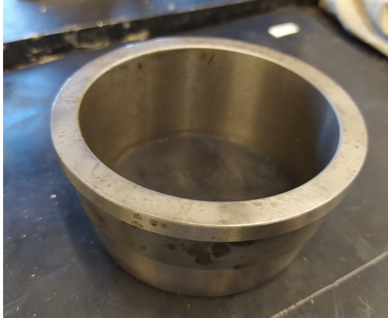
Obr. 31: Použitý vysekávací nůž pro výrobu zkušebních tělísek určených pro zkoušku tečení materiálu během dvouosého zatížení
