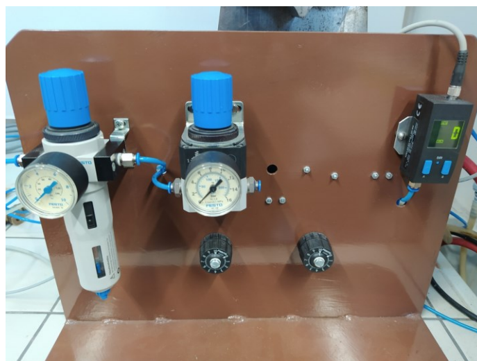
Obr. 36: ovládání stlačeného vzduchu k nastavení požadované hodnoty tlaku a zatížení
