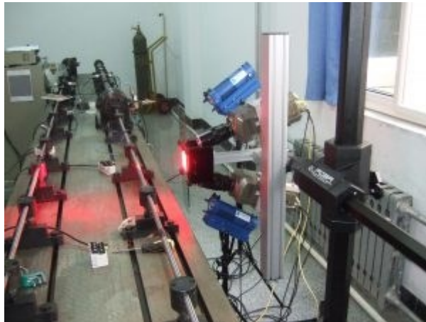
Obr. 7: nastavení kamer během Hopkinsonového tyčového testu [10]
