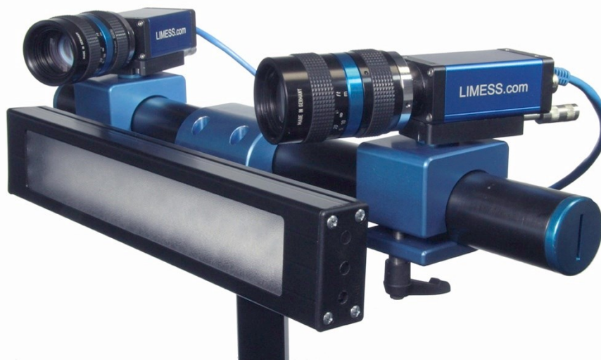
Obr. 2: Struktura DIC systému – soustava kamer a světel [32]
