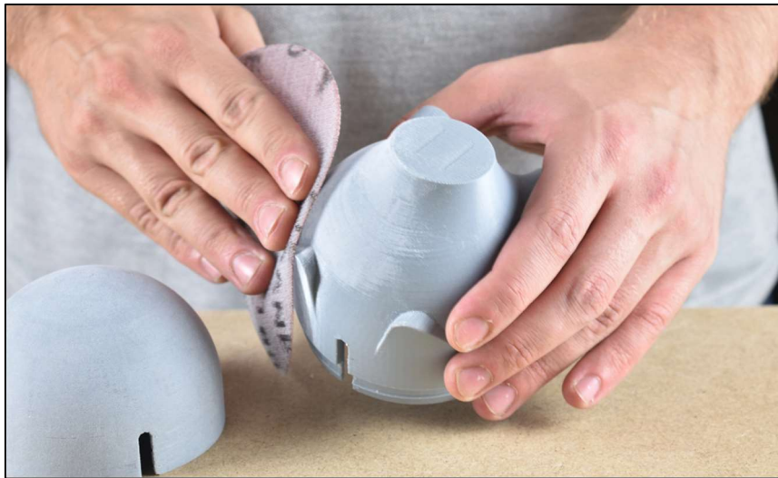
Obrázek 17 – Broušení výtisku (Sharplayers.cz, 2022)
