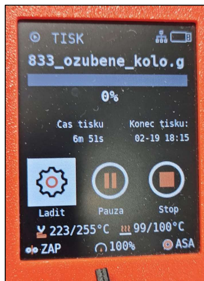
Obrázek 31 – Parametry tisku na displeji tiskárny
