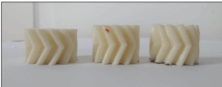
Obrázek 33 – Ztráta tvaru působením horkému vzduchu
