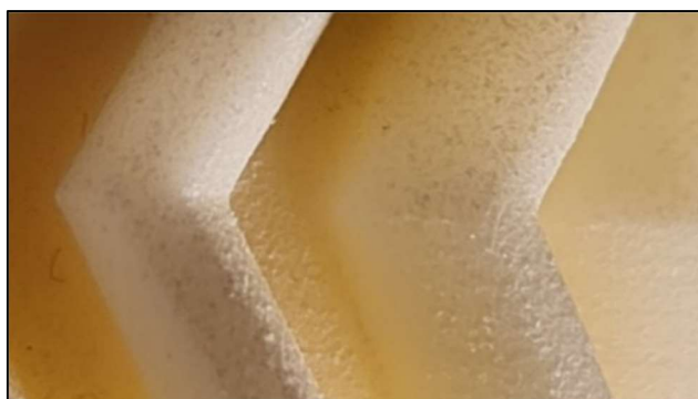
Obrázek 35 – Povrch vzorku po pískování
