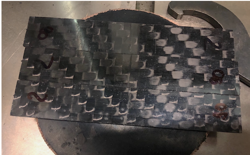
Obr. 69 Vzorky ze souboru 2-90° po únavové zkoušce cyklickým zatěžováním
