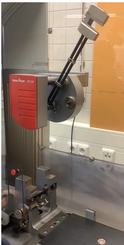
Obr. 36 Charpyho kladivo Zwick/Roell HIT 25P – ustavení zkušebního tělíska
