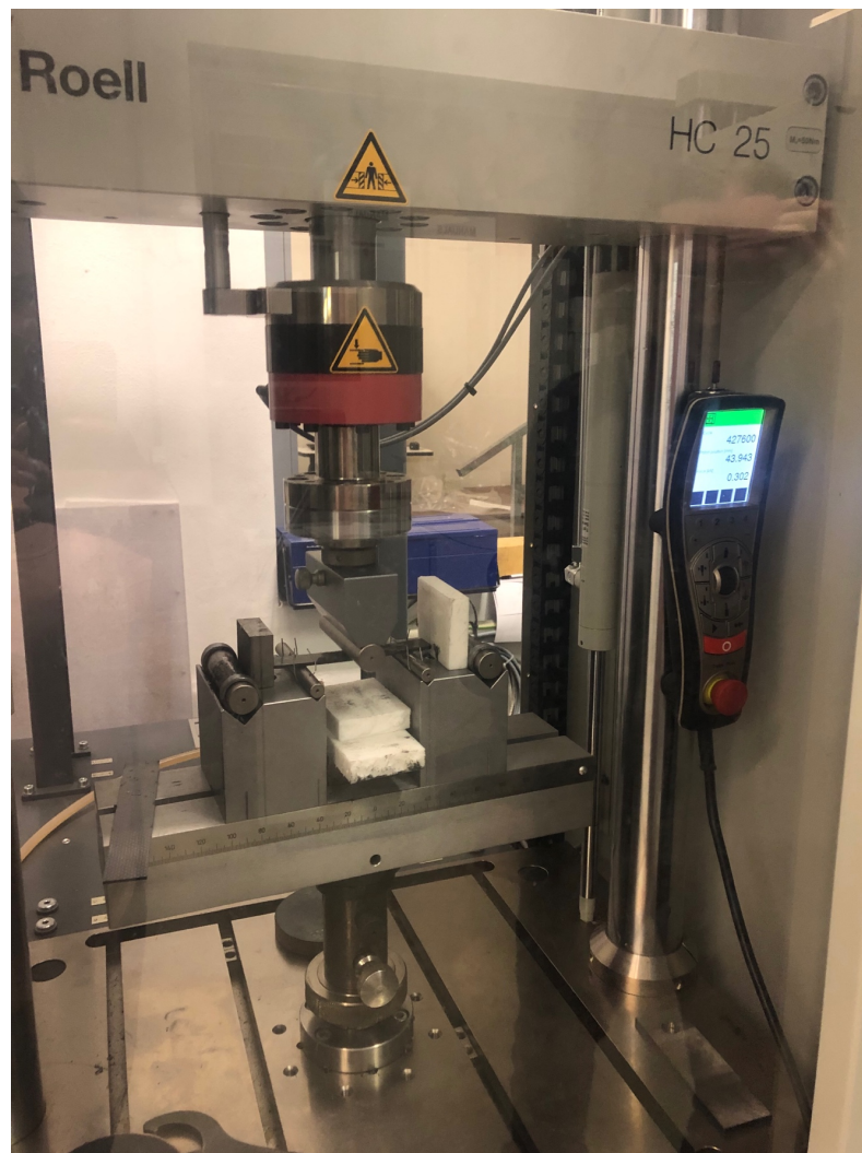
Obr. 58 Cyklická zkouška vzorku 2–90° na stroji Zwick HC25
