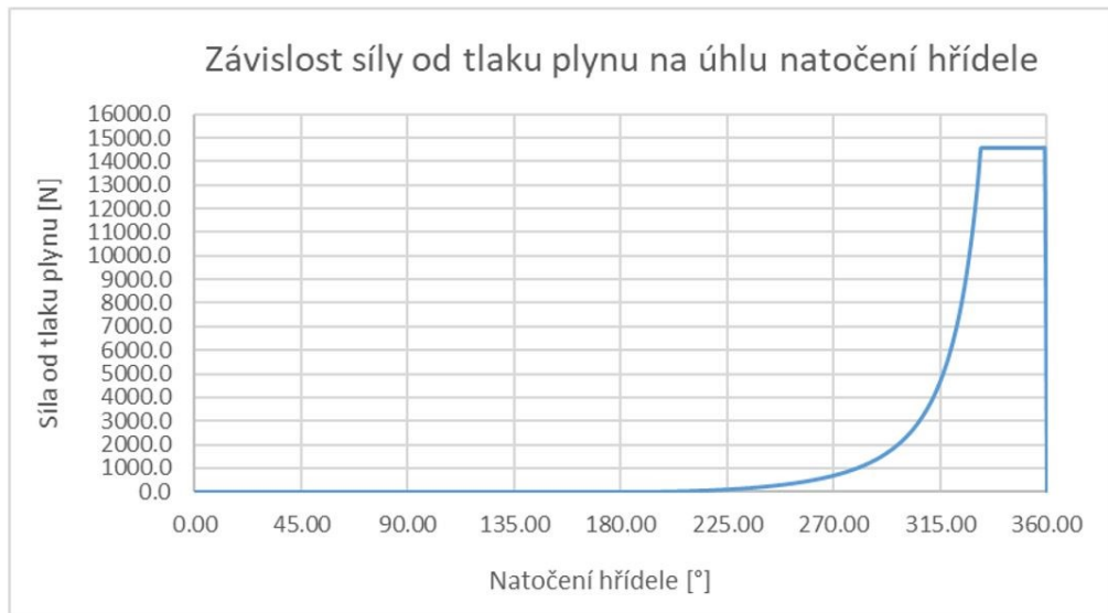
Obrázek 39 Závislost síly od tlaku plynu na natočení hřídele
