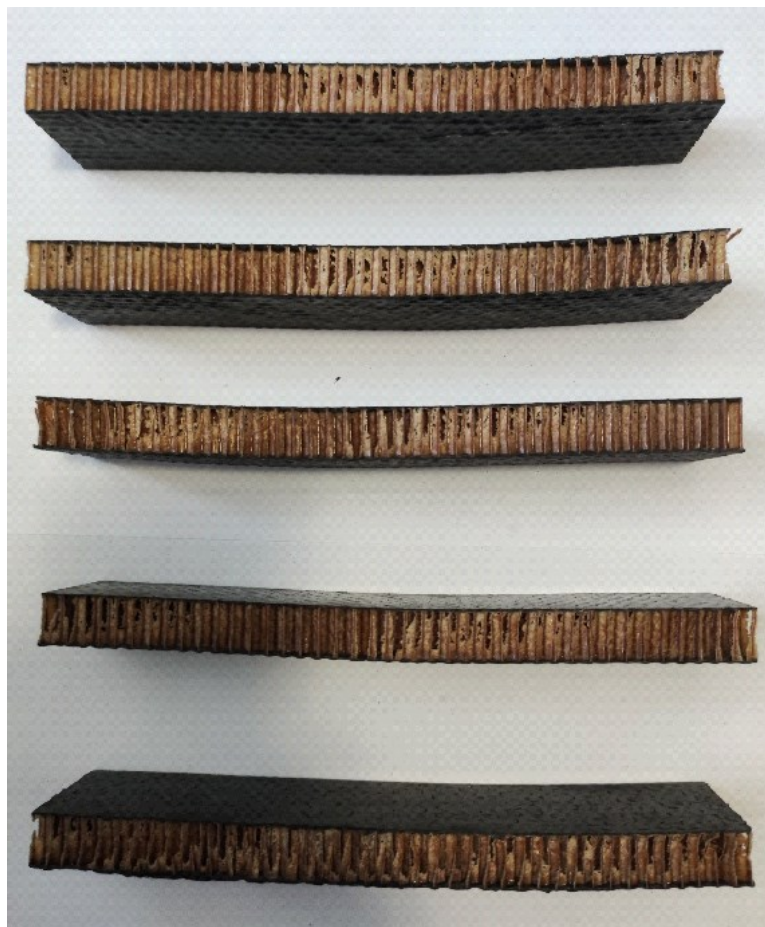
Obrázek 53 Poškozené vzorky s nomexovou voštinou
