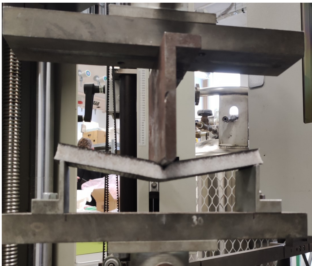
Obrázek 46 Zkouška třibodovým ohybem
