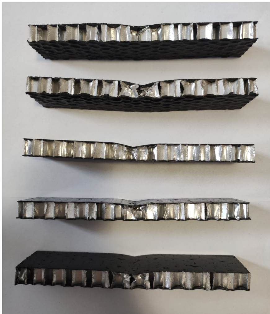
Obrázek 47 Poškozené vzorky s hliníkovou voštinou
