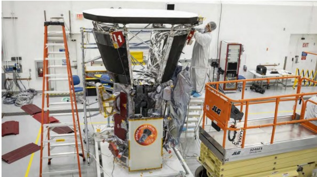
Obrázek 34 Instalace tepelného štítu na kosmickou loď Parker Solar Probe [33]
