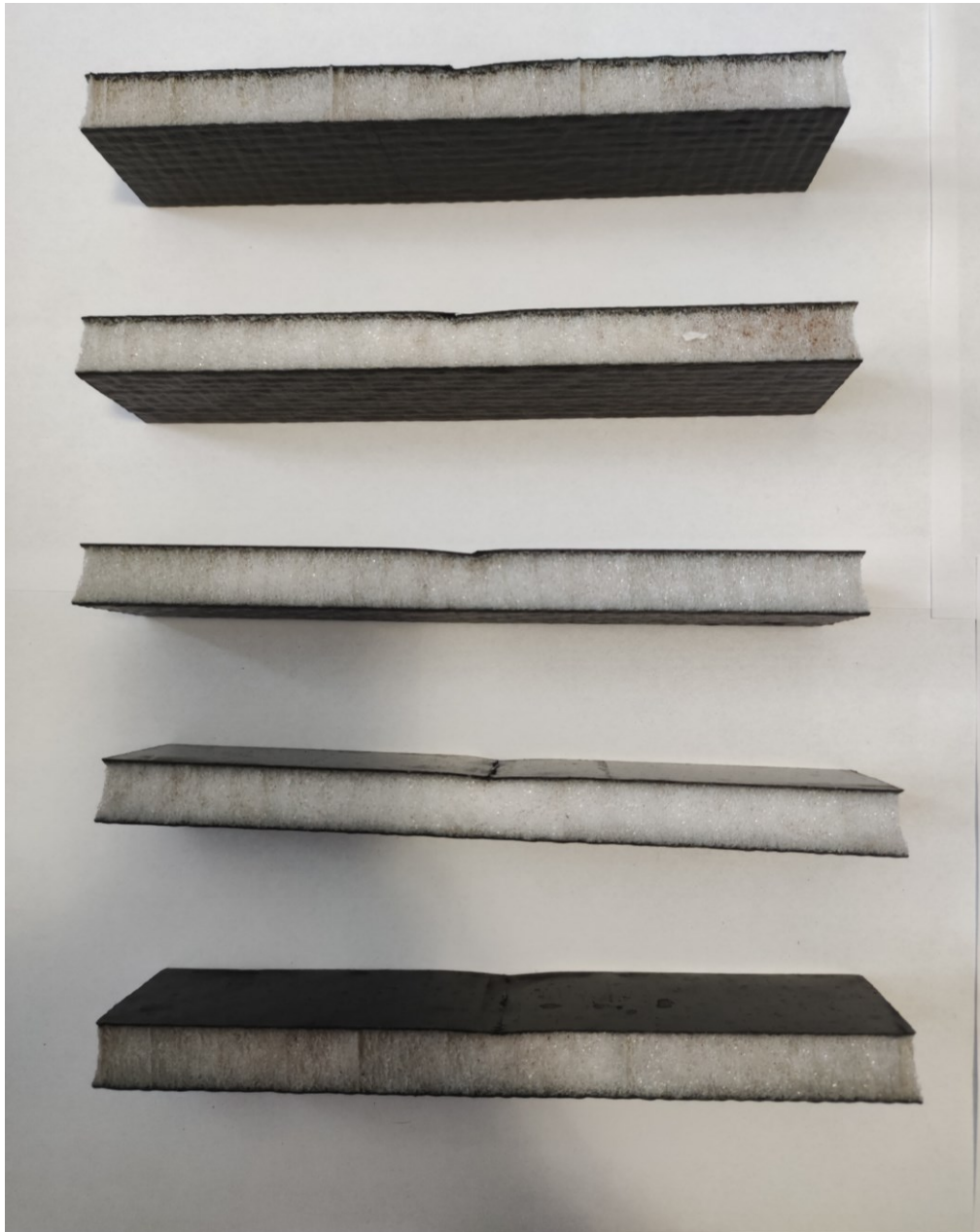
Obrázek 50 Poškozené vzorky s pěnovým jádrem
