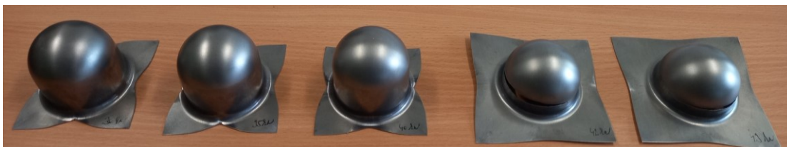
Obr. 39 Výtažky ze zkoušky bez brzdící drážky
