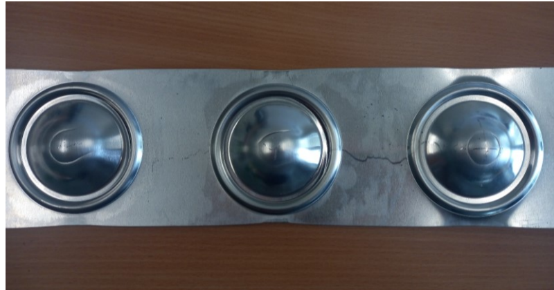
Obr. 35 Výtažky ze slitiny hliníku EN AW-1050A tl. 1,5 mm
