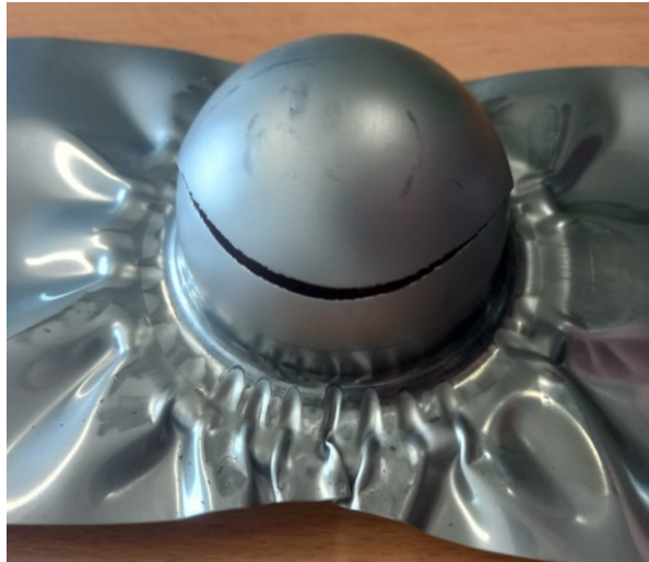
Obr. 37 Zvlnění materiálu 1.4301 při použití malé přidržovací síly
