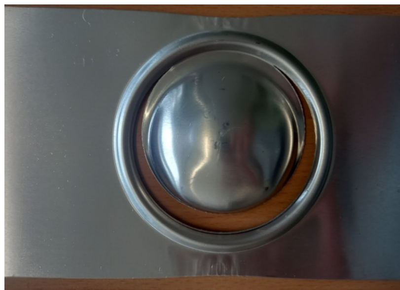
Obr. 36 Prasklina u materiálu EN AW-1050A tl. 0,5 mm
