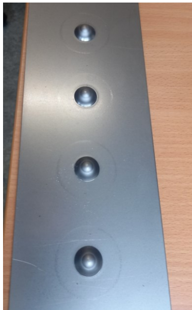
Obr. 34 Výtažky po zkoušce dle Erichsena u materiálu DC01
