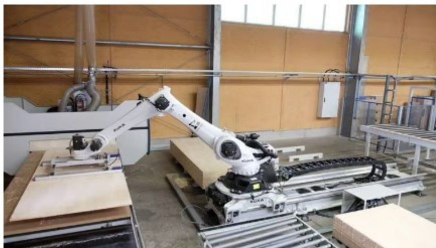
Obr. 55. Příklad automatizace procesu plnění obráběcího centra [47]
