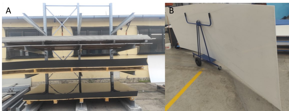
Obr. 45 A) Nevhodný regál – vzniká prohnutí materiálu, B) Vzniklý průhyb desky při manipulaci na vozíku
