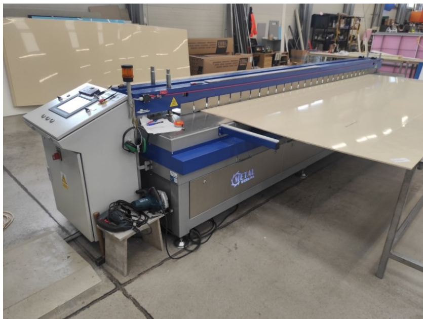
Obr. 23 Svařovací pravítko BWM 4200
