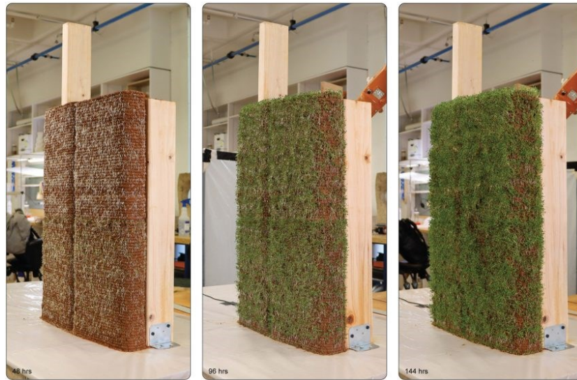
Obrázek 10 3D vytištěná živá stěna [12]
