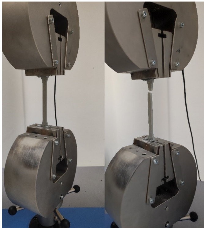
Obrázek 34 Tah zkušebního tělesa před a po zkoušce
