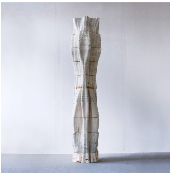
Obrázek 8 Sloup z mycelia [9]
