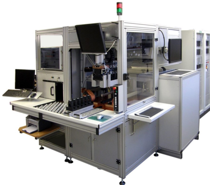
Obrázek 35. Systém pro zkoušení přístrojových transformátorů proudu od společnosti ZERAGmbH [38]
