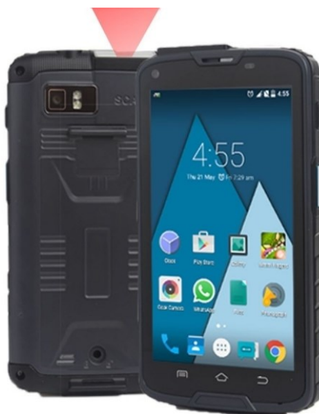
Obrázek 45. Průmyslová čtečka čárových kódů. Zdroj: (CRUISER BH05 - průmyslová čtečka čárových 2D kódů, čtečka UHF RFID, b.r.)
