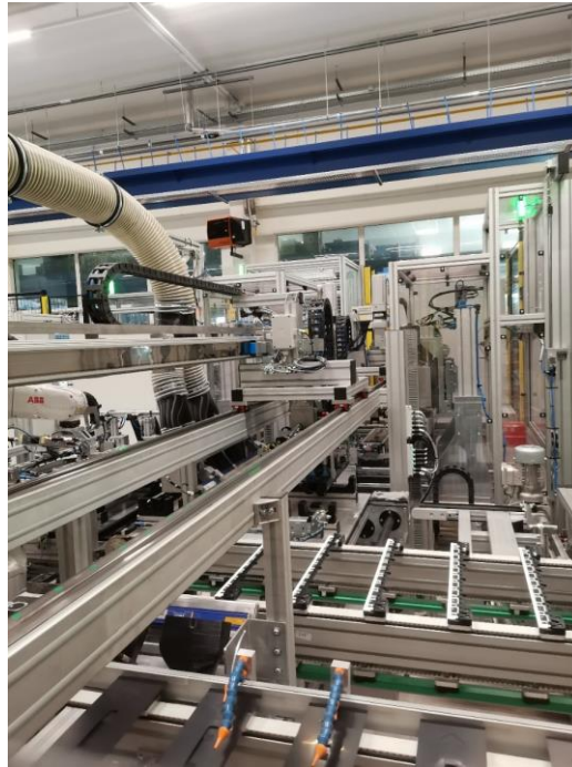
Obrázek 18 Prostřední část linky obsluhována mechanickým ramenem na lineárních pojezdech (vlastní fotografie)
