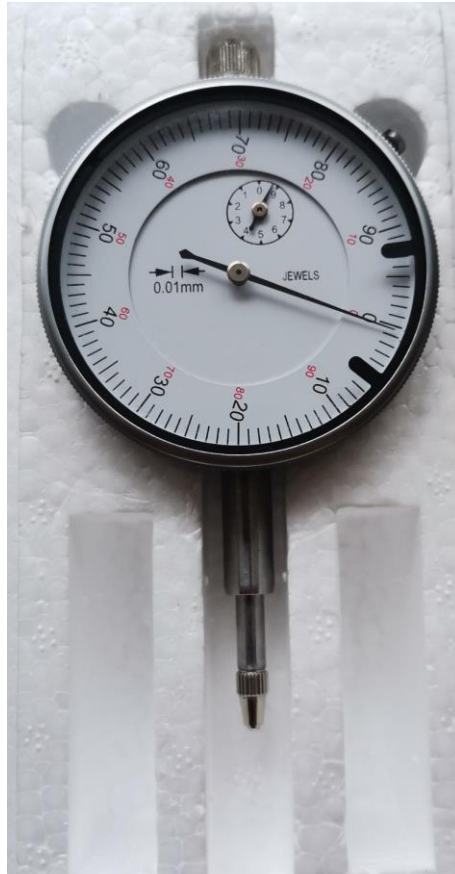
Obrázek 38 Úchylkoměr pro měření odchylek (vlastní fotografie)
