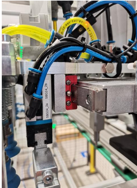
Obrázek 37 Zobrazení lineárního pojezdu a lineárního ložiska (vlastní fotografie)
