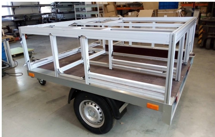
Obr. 47 montáž základní konstrukce s ochranou fólií
