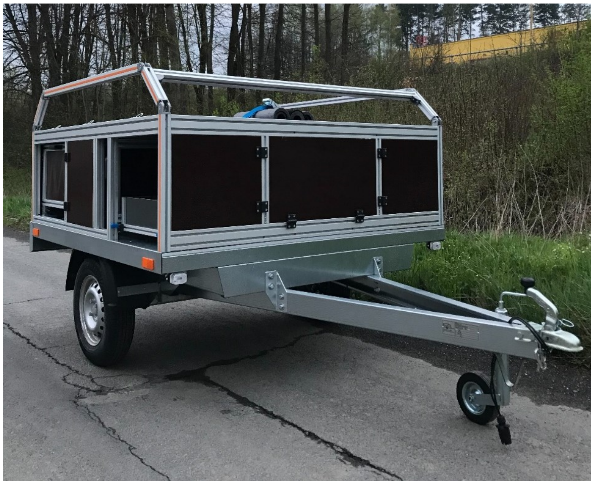
Obr. 52 finální konstrukce přední část
