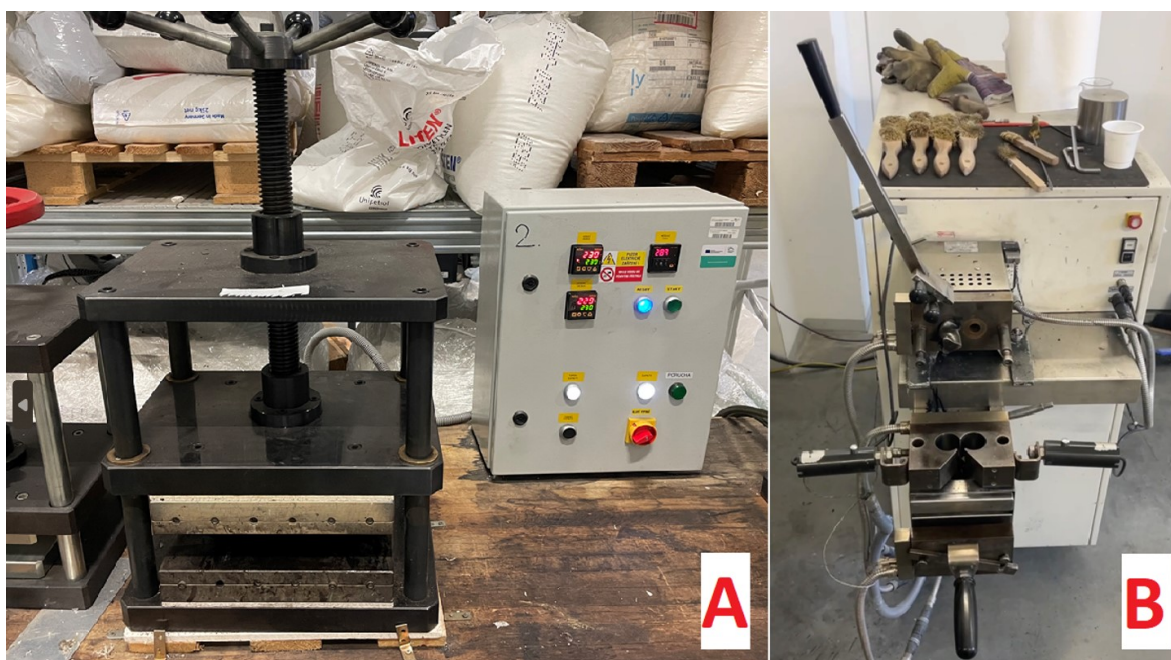
Obrázek 19: Manuální lis pro přípravu jednotlivých vzorků (A) a použité zařízení pro přípravu polymerních směsí Brabender Plastograph (B)
