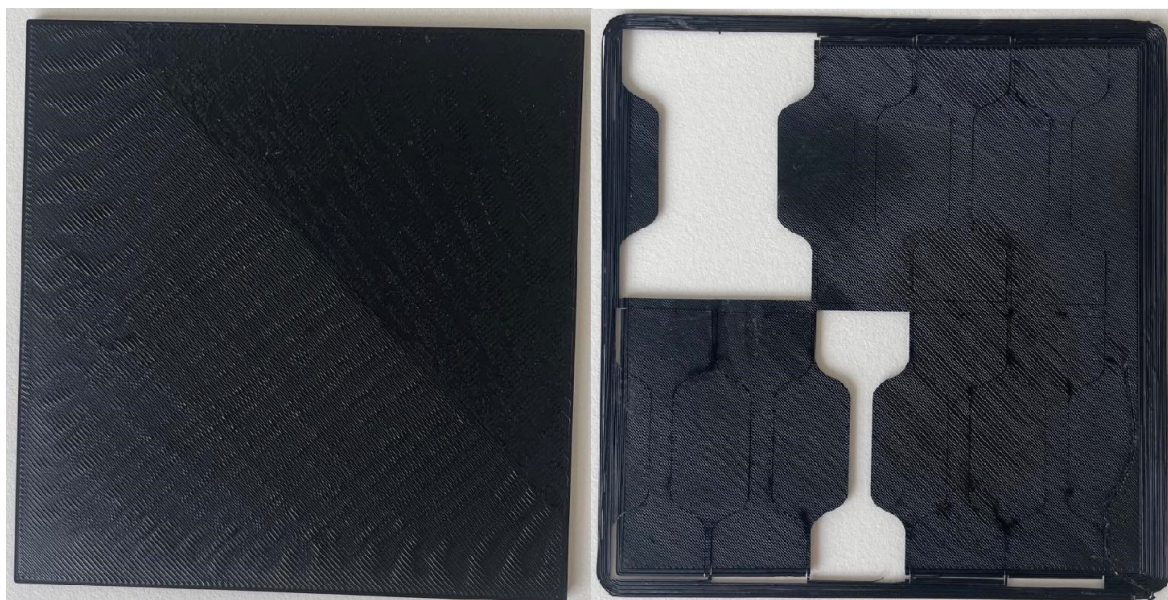
Obrázek 40: Vytisknutý vzorek (vlevo) a následně vyřezané lopatky ze vzorku za pomoci laseru (vpravo)
