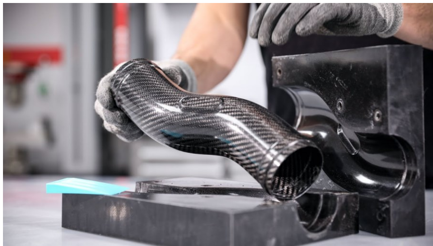
Obrázek 11 – Odformování kompozitního dílce [47]
