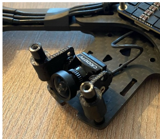
Obrázek 23. Osazení kamery do rámu
