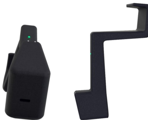
Obrázek 37 Dokovací díl s nabíječkou
