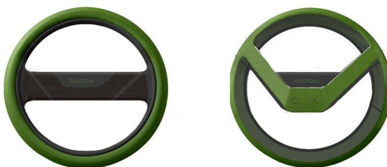
Obrázek 23 První Photoshop rendery volantu, s tlačítky umístěnými pod textilií
