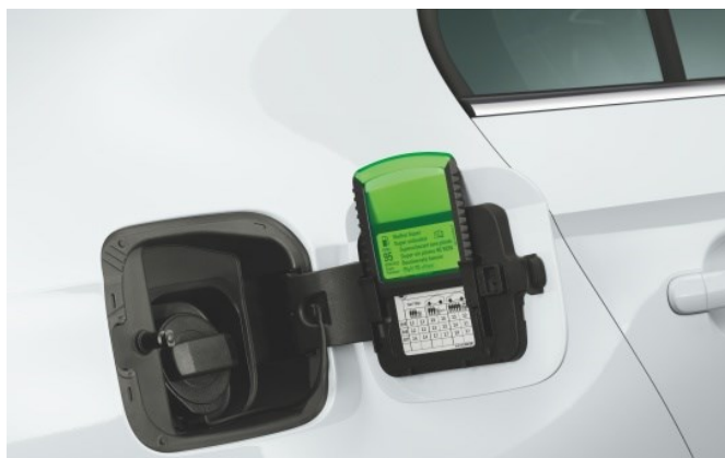
Obrázek 12 Trapézová škrabka na led uložená v krytu hrdla palivové nádrže
