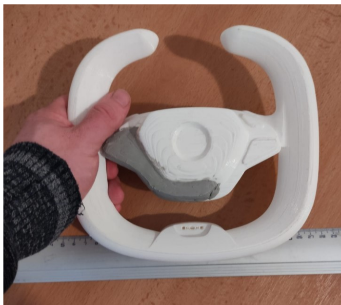
Obrázek 33 Úprava ergonomie ovladače
