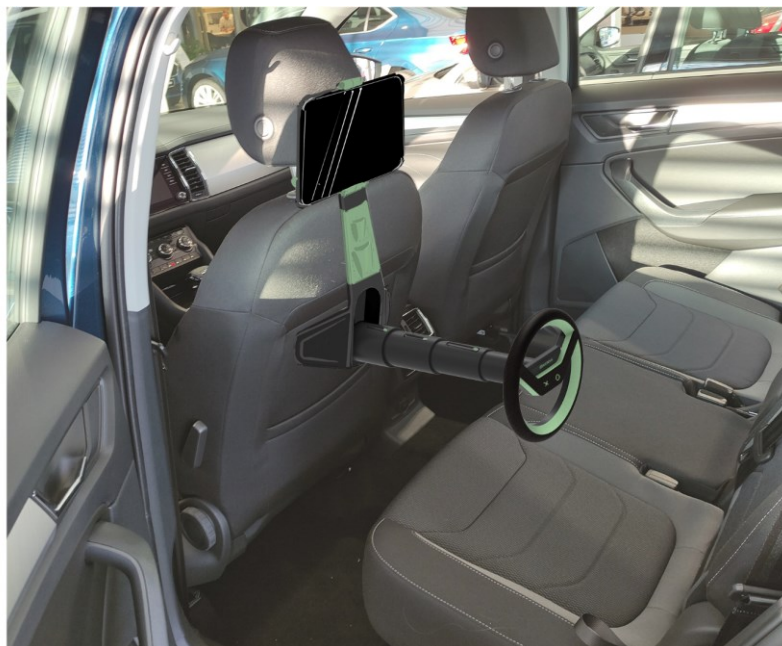
Obrázek 16 Ukotvení z hlavové opěrky verze 1
