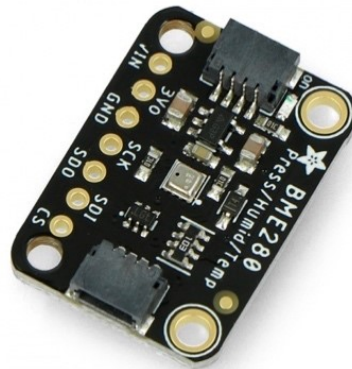
Obrázek 14. Senzor teploty, vlhkosti a tlaku – BME280 [65]
