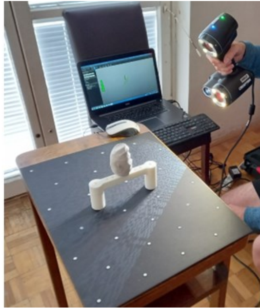
Obrázok 2: Skenovanie makety 3D skenerom
