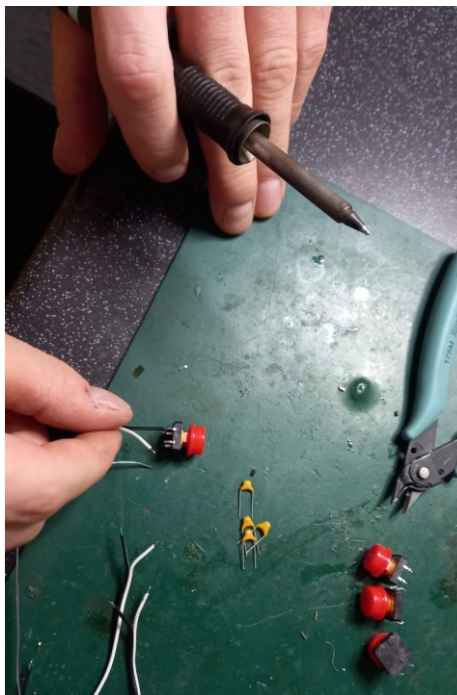
Obrázok 6: Spájkovanie tlačidiel ku káblikom
