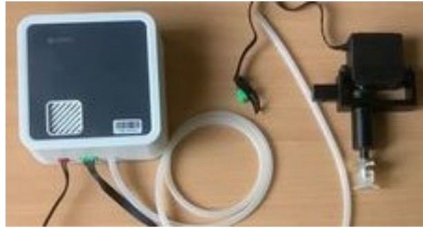
Obrázek 11 – Přísavka a pumpa fungující jako vývěva/kompresor[28]
