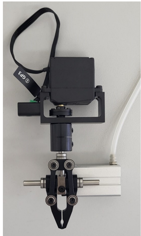
Obrázek 41 a 42 – Připojení nástavce kleští
