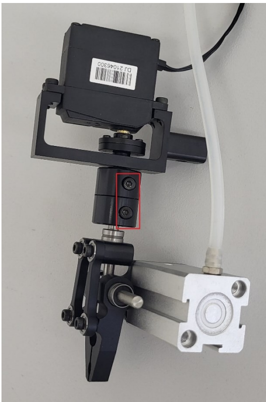
Obrázek 41 a 42 – Připojení nástavce kleští
