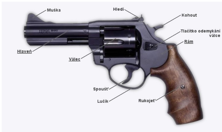
Obrázek 3. Popis hlavních částí a ovládacích prvků revolveru [10]
